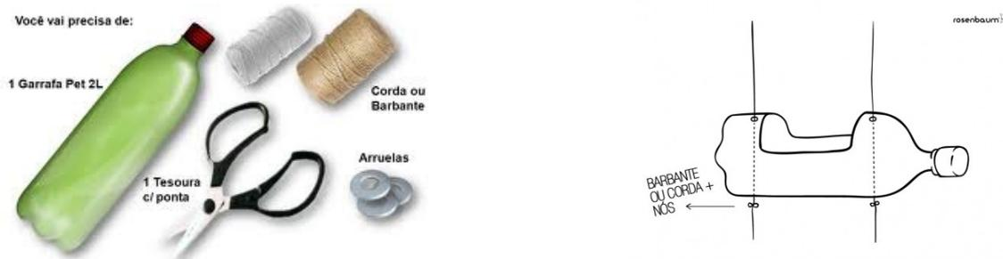
Serão feitos furos na garrafa pet, por onde passará o barbante para ser fixado na parede e serão feitos alguns furos na parte inferior da garrafa para o escoamento de água.
